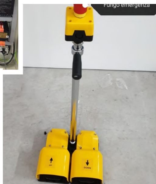
Impianto elettrico con componenti Siemens modolo di sicurezza e pedaliera della Pizzato
